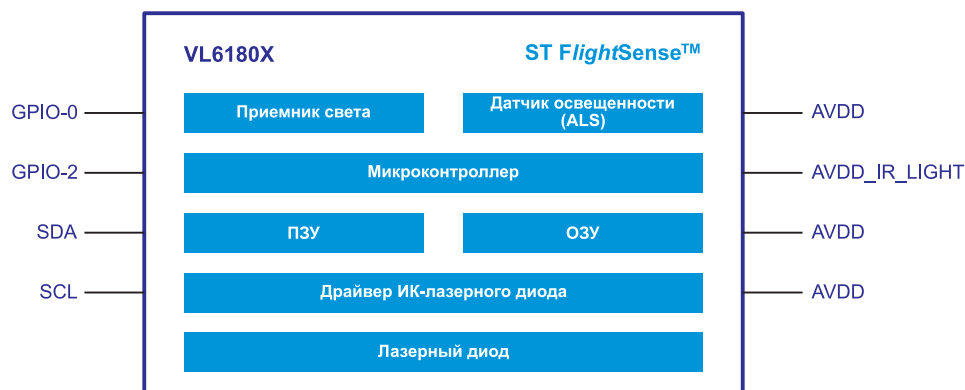
Рис. 5. Архитектура датчика VL6180X
