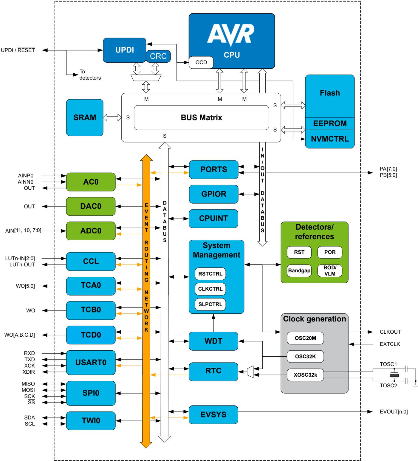
Figure 3-2. ATtiny814 Block Diagram
