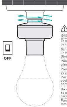
安装灯座前，请关闭电源，以免触电！
